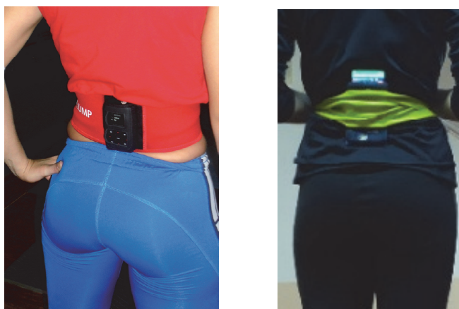
Рис. 2. Крепление измерительного устройства FreeSense (слева) и смартфона с приложением Physics Toolbox Accelerometer (справа) Fig. 2. Fixation of the FreeSense measuring device (left) and a smartphone with the Physics Toolbox Accelerometer app (right)
