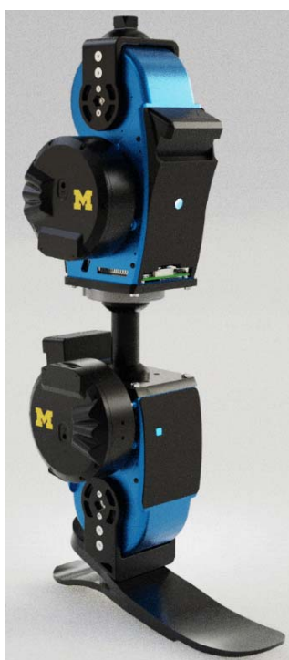
Рис. 6. Проект создания бионической ноги с открытым исходным кодом Open-source Leg
